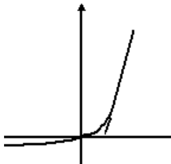
Рисунок 1 - Вольт-амперная характеристика диода (ВАХ)
